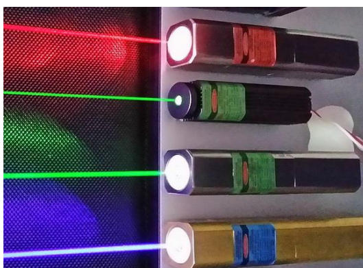
圖 3 雷射二極體發出可見雷射
