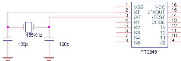
圖 2-5-2 PT2248 振盪器輸入電路
