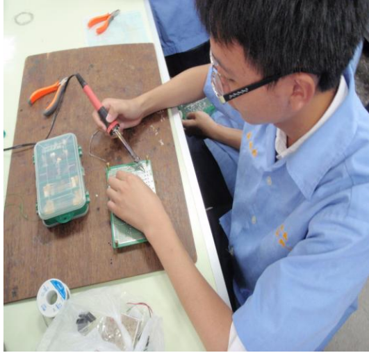
圖 4-1-1 焊接電路過程
