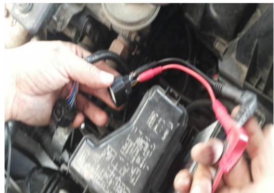
圖 1-2 安裝 P 檔和 N 檔外接線
