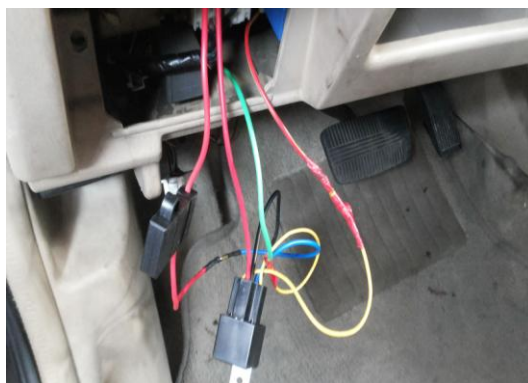
圖 1-5 P, N 檔線路串連繼電器
