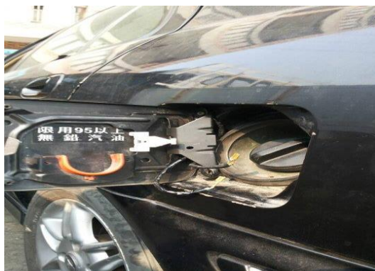
圖 1-6 油箱蓋線路安裝
