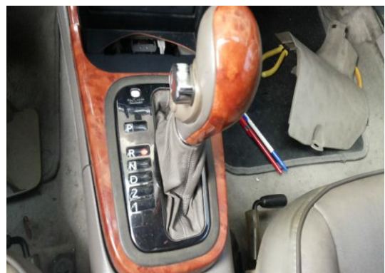
圖2-6 將檔位排至D或R檔進行測試
