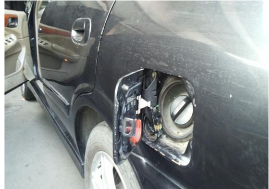
圖2-7 排到R檔後將油箱蓋打開
