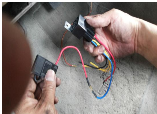
圖 1-3 外接噴油嘴保險絲座和繼電器開關
